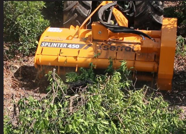
Trituradora con doble alimentador hidráulico ideal para restos de olivo, cítricos y frutos secos de hasta 5-7 cm de diámetro, con el rotor SPLINTER de SERRAT para tractores de entre 70 y 140 C.V.
