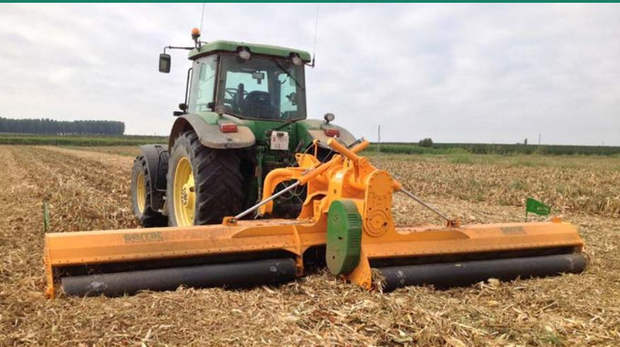
A Abatible agrícola é uma composição de duas máquinas standard, sobrepostas no trabalho, unidas por um corpo central com sistema de auto-dobragem. A composição pode chegar a os 6,30 m de largura. O desenho da sua transmissão colocada no seu interior, deixa as laterais limpas de obstáculos para uma melhor aproximação as coberturas, etc. O seu uso vai dirigido a trituração de pasto e agricultura em geral (milho, sorgo, algodão) ou para cegar ervas em pastagens, aeroportos, etc. A articulação
