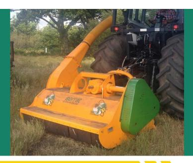
A trituradora BIOGREEN, em apenas uma passagem, e a uma velocidade constante, é capaz de cortar e arremessar a e rva e aparas de mato para um contentor, de maneira a deixar o terreno limpo.
