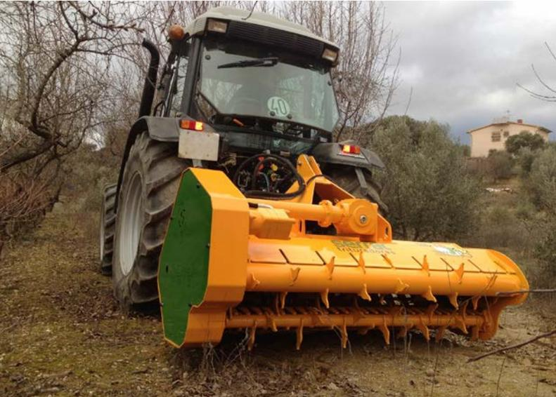
Triturador com duplo alimentador hidráulico. Ideal para restos de olival, citrinos e frutos secos até 6-8 cm de diâmetro, com crivo traseiro substituível para determinar o tamanho do material triturado. Para tratores entre 70 e 120 C.V.
