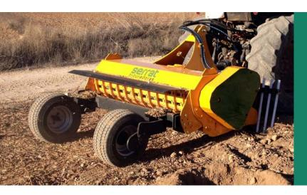
Trituradora com alimentador hidráulico reversível, para restos de vinha, oliveiras, amendoeiras, etc. Ate um diâmetro de 5 cm. Com o ancinho inferior de ataque variável, consegue-se levantar o material do chão, independentemente das características do terreno.
