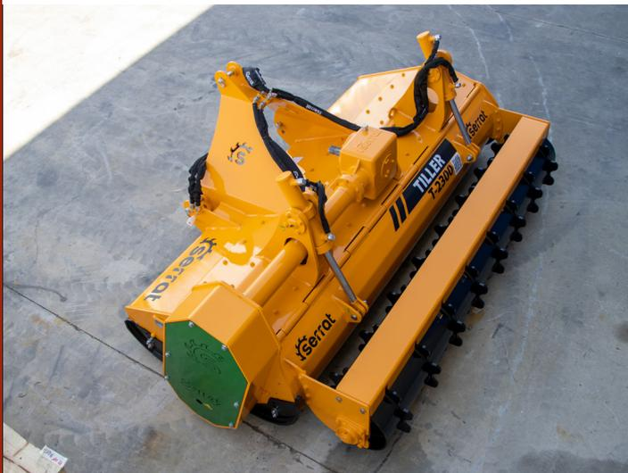
Máquina de preparação do solo até uma profundidade de 180 mm, para tratores entre 100 - 150 CV.
