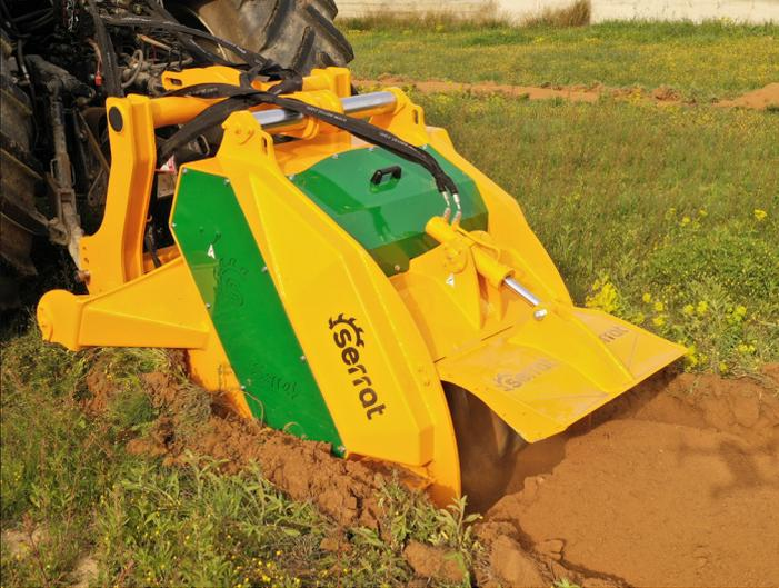
Máquina de preparación de suelo hasta una profundidad de 40 cm, para tractores entre 180 - 250 CV.
