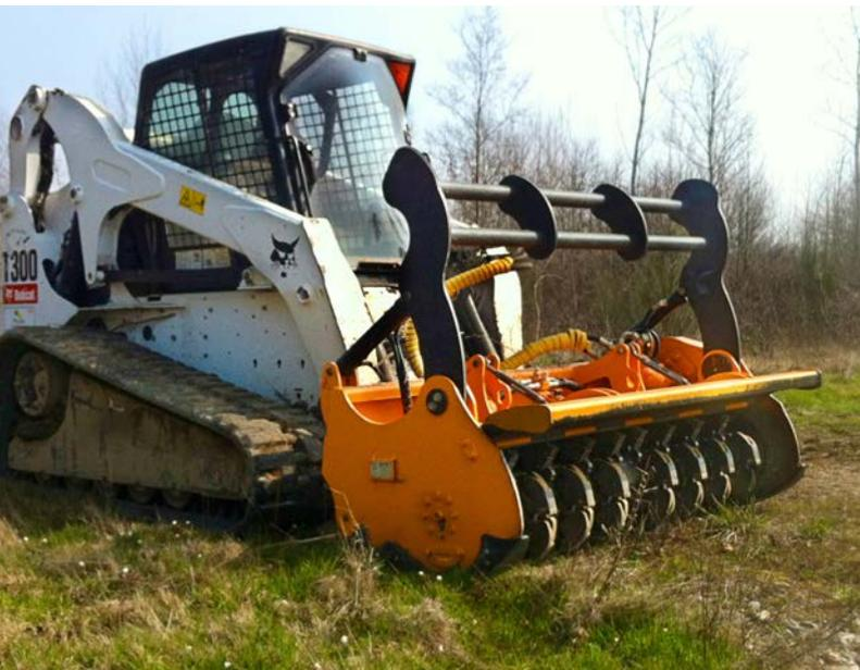
Trituradora para acoplar a cargadoras dentre 3 e 5 t. de rodas ou correntes, utilizando-se em trabalhos de desbroce e manutenções florestais, jardinería industrial, etc. combinando a maniobrabilidade de uma cargadora rígida e as prestações de uma trituradora.
