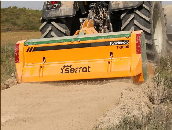
Máquina de preparação do solo até uma profundidade de 50 cm, para tratores entre 250 - 500 CV.
