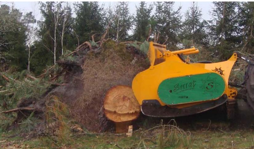
Trituradora florestal adaptável a todo o tipo de tractores entre os 250 - 350 CV. Equipada com um rotor de dente fixo com sistema Fixe Top, para madeira grossa e cepos. Esta máquina incorpora todas as opções possíveis de serie, necessárias para realizar um óptimo trabalho florestal.
