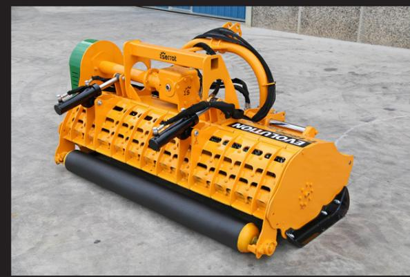
Trituradora de martelos, para a eliminação de restos de poda de até 80 mm e manutenção do manto vegetal. Ideal para a regeneração de praderas e pastizales.
