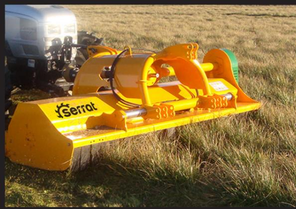
Trituradora de martelos, para a eliminação de restos de poda de até 80 mm e manutenção do manto vegetal. Ideal para a regeneração de praderas e pastizales. Rotor POLSER de 450-500 mm de diâmetro. Excelentes resultados em jardinería industrial e manutenção de arceas. Sua configuração reversível e móvel permite que a máquina seja operada bem na parte traseira, bem como na parte dianteira tripuntal e em tratores reversíveis, para não pisar no material a ser esmagado.
