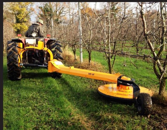
Disco-satélite de eixo vertical e acionamento mecânico para corte de erva por debaixo das vedações de gado, árvores de fruta e rails, etc.
