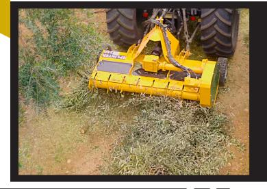
O triturador com alimentador hidráulico duplo, ideal para azeitonas, frutas cítricas e secas, mantém até 60 mm de diâmetro, com o rotor SERRAT SPLINTER para tratores entre 60 e 120 CV.
