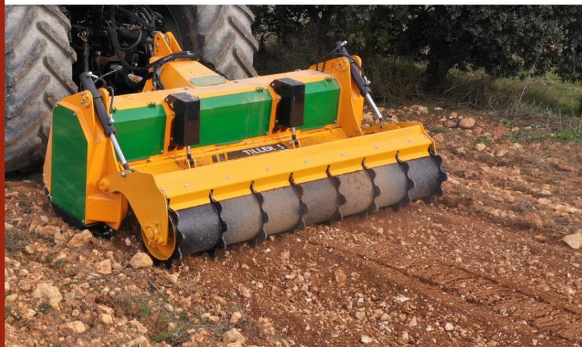
Máquina de preparação do solo até uma profundidade de 300 mm, para tratores com Creeper ou Vario entre 130 - 180 CV.
