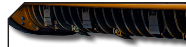
Martelos florestais forjados SERRAT, dente retrátil de 360°
