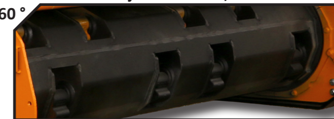
Dente fixo com ponta de tungstênio
