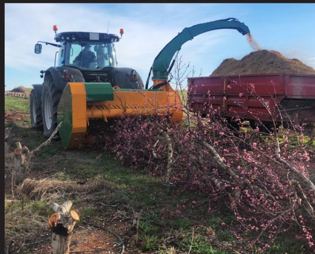
Maquina trituradora recuperadora de madeira de poda para acoplar a tratores de 300 – 500 CV. Sistema de boot HIDRAHELP.
